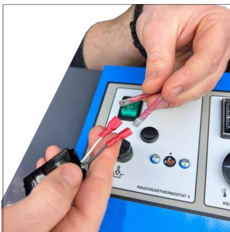
5. Liitä painikkeen 2 kaapelia kuvan mukaisesti AS-ajastimen painikeliitäntöihin – napaisuutta ei tarvitse
