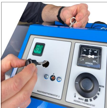
4. Käytä painiketta kuvan mukaisesti kuvassa nyt paljastuneeseen aukkoon ja lukitse se aluslevyllä + mutterilla.
