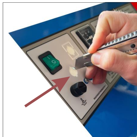
3. Poista leikkuuveitsellä kalvo pois pyöreästä peitetystä kohdasta metallilevyssä.
