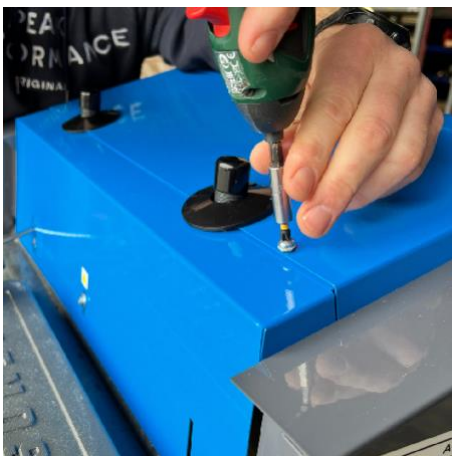
1. Irrota kattilan yläkannen ruuvit.
